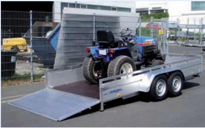
BTSL 3540/185 Rampe aus Aluprofilen (Höhe: 1000 mm)
