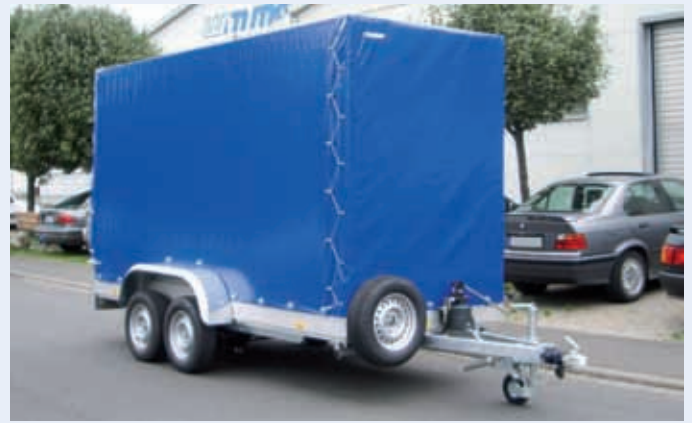
BTSL 3040/151 Zubehör: Plane (Serienfarben: Blau oder Grau) und Spriegel, Ersatzrad mit Halter
